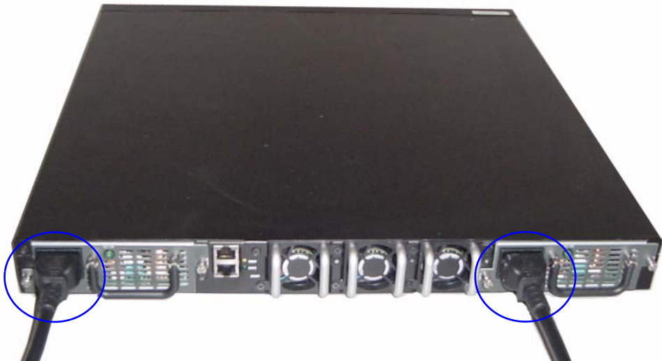
Figure 2. Branchement des câbles d'alimentation
