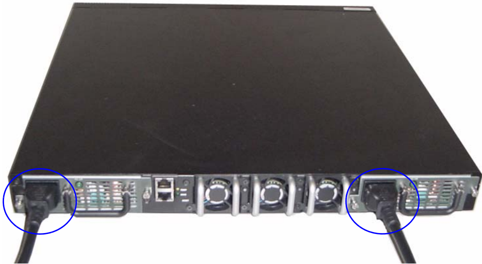
図 2 電源ケーブルの接続
